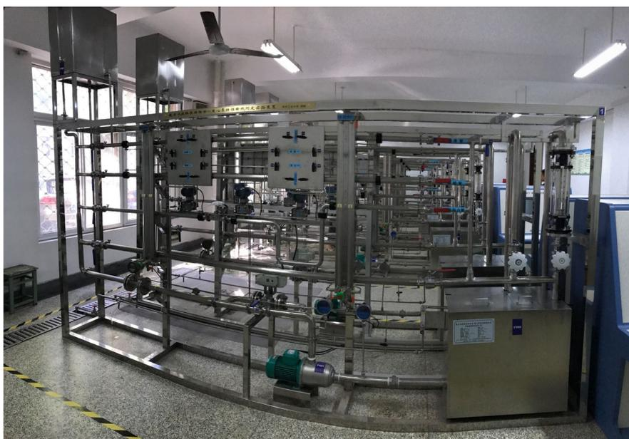
图 1-2 流体流动综合实验装置实物照片
