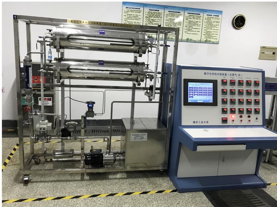
图 2-2 水蒸气-水体系传热实验装置实物照片
