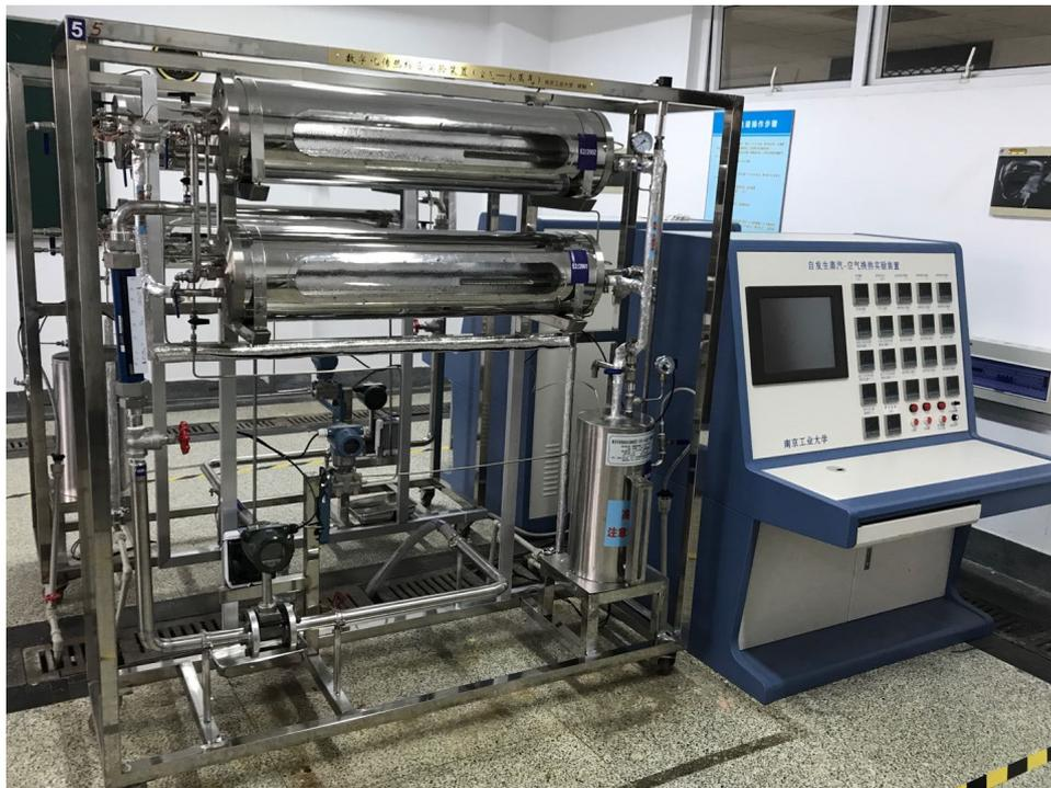
图 2-4 水蒸气-水体系传热实验装置实物照片
