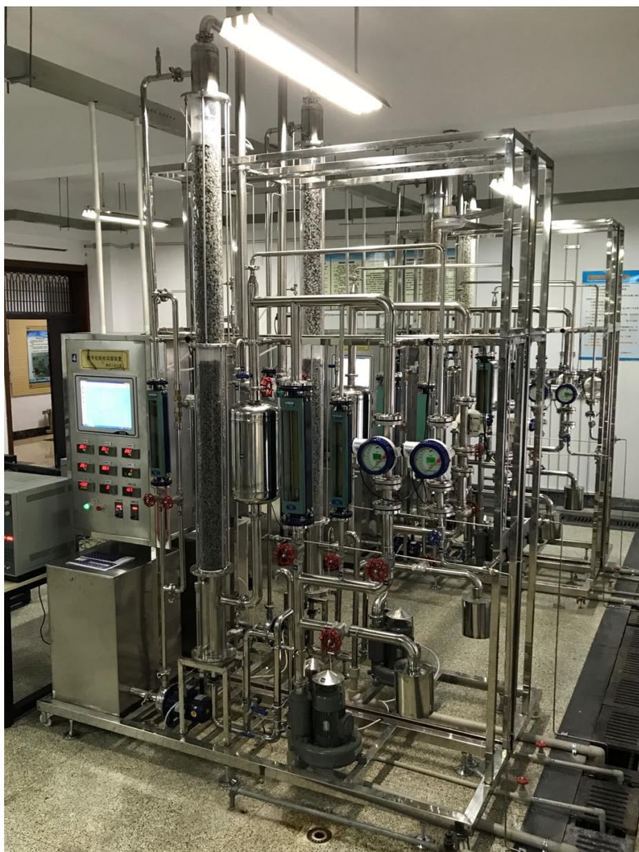
图 3-2 吸收综合实验装置实物照片
